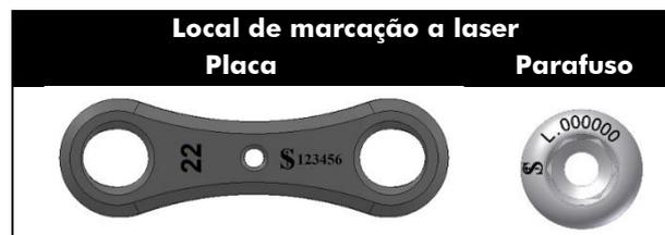
O local a ser efetuada a marcação dos produtos é eleito conforme descrito na norma ABNT NBR 12932 – Implantes para cirurgia - Materiais Metálicos - Preparação de superfície e marcação, e é efetuado em regiões de baixas concentrações de tensões onde não cruzam com escareados ou bordas dos implantes. Nos rótulos e etiquetas constam os dados do produto como código, descrição e lote do mesmo, entre outras informações como fabricante, e o número do registro do produto na ANVISA.
